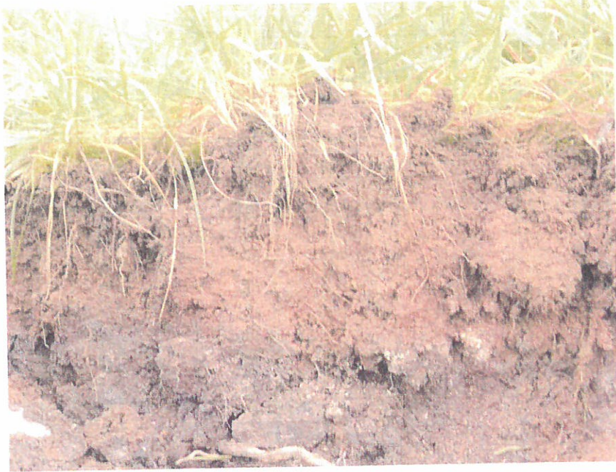
Figure 7 : Aspect de la couverture de recouvrement des déchets
